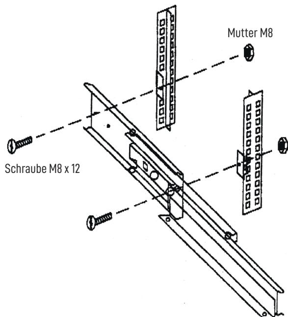
3. Die Teleskopauszüge mit je 2 Schrauben M8 x 12 und 2 Muttern M8 an die Befestigungsklammern anschrauben.
