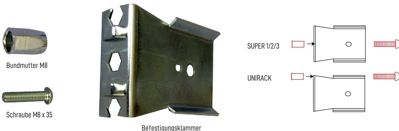
2. Die 4 Befestigungsklammern in gewünschter Höhe in die Pfosten mit dem Hammer einklopfen und mit der Schraube M8 x 35 am Pfosten arretieren.
